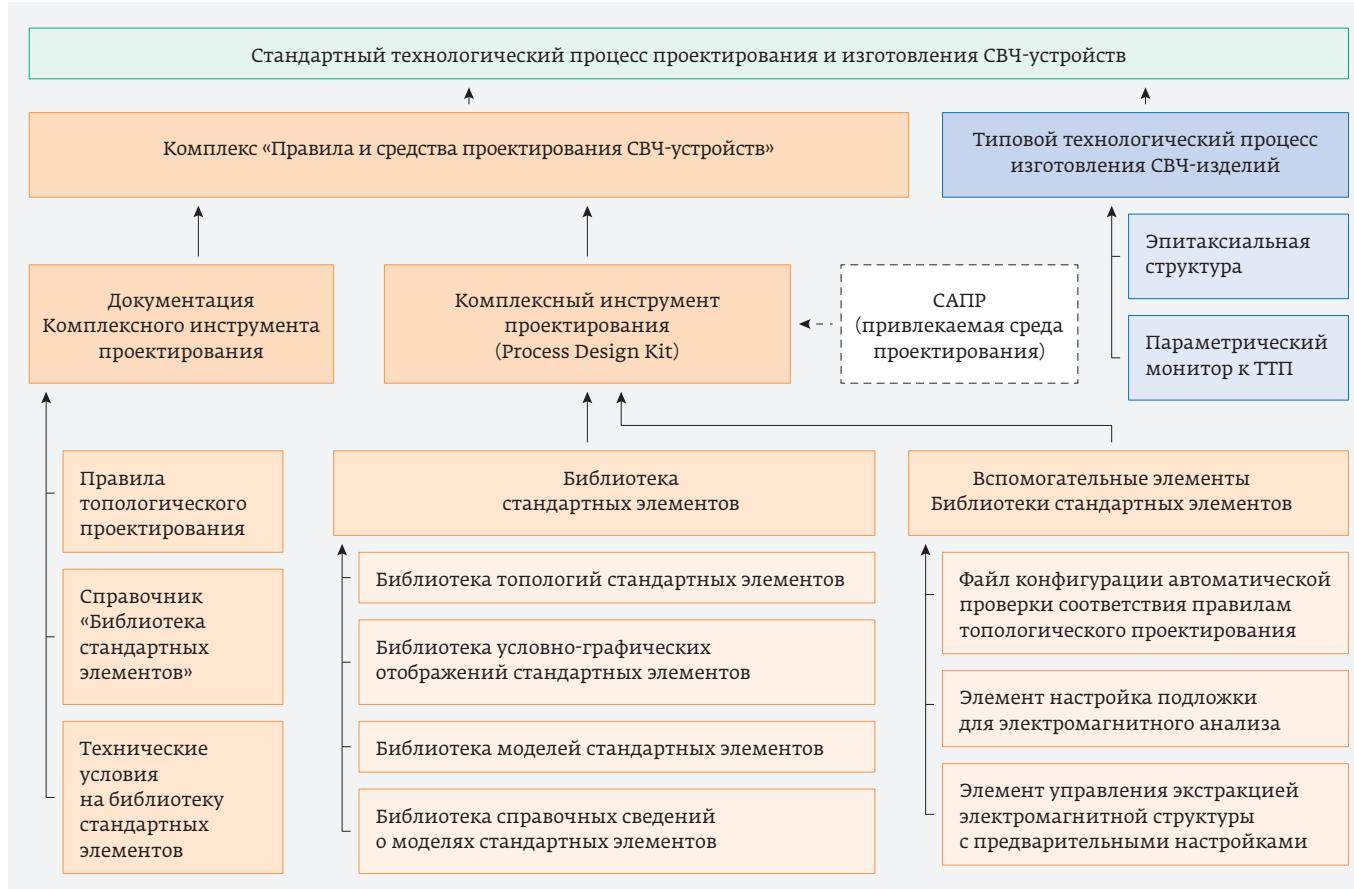
Рис. 1. Структурная схема стандартной технологии проектирования и производства СВЧ МИС
