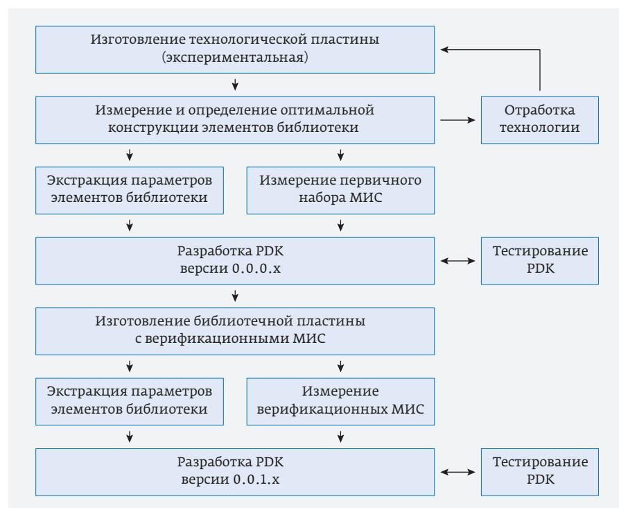
Рис. 4. Блок-схема процесса создания и верификации PDK
