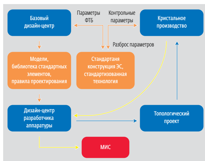
Рис.3. Структурная схема разработок и производства изделий полупроводниковой техники, реализованная на предприятиях TriQuint Semiconductor, RF MicroDevices, OMMIC и др.
