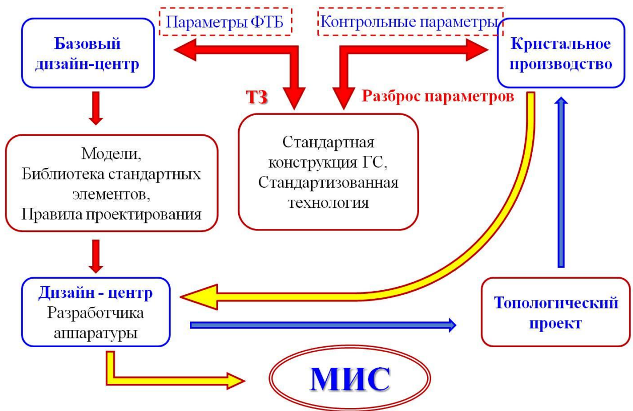
Рис. 3. Структурная схема разработок и производства изделий полупроводниковой техники
